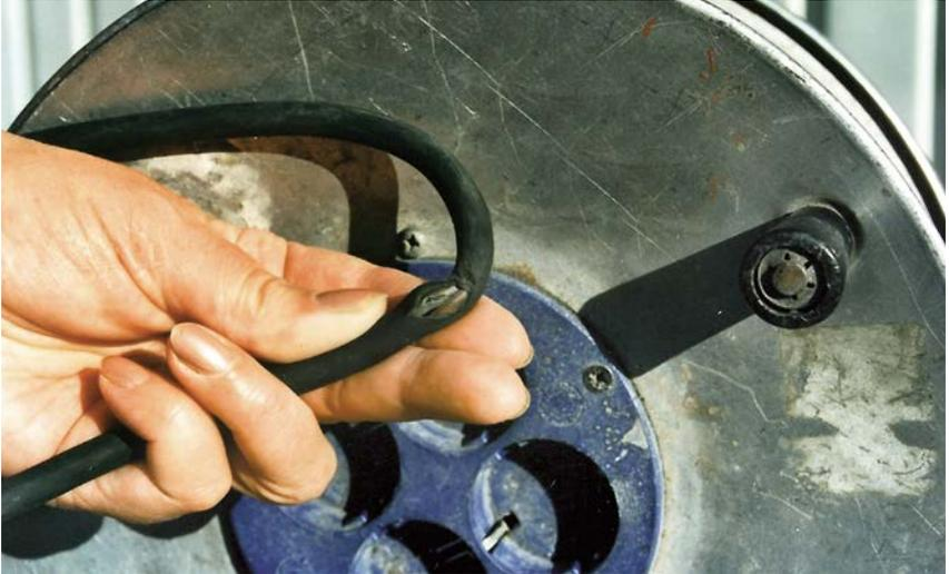
**Abb. 3.4** Beschädigte und für den Bereich Bau- und Montagestellen ungeeignete leichte Gummischlauchleitung Typ H05RR-F; außerdem weisen die Steckdosen nicht die notwendige Schutzart IP X4 auf.
