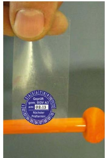
Abb. 3.21 Prüfbänderole zur Befestigung an der Anschlussleitung
