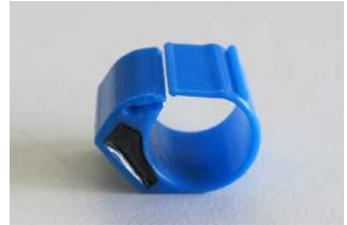
Abb. 3.23 RFID zur Befestigung an der Geräteanschlussleitung
