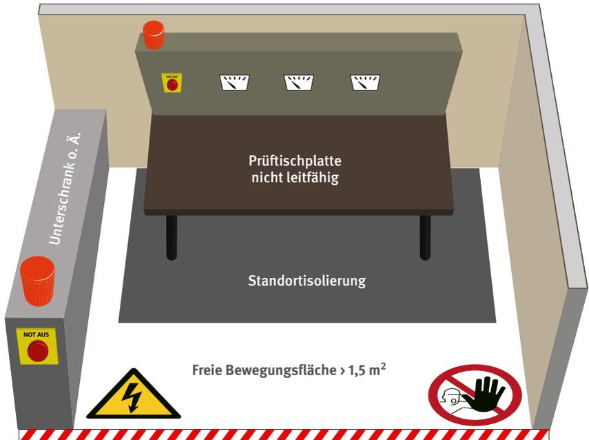
Abb. 6.1 Beispiel für einen Prüfplatz in einer Elektrowerkstatt.
